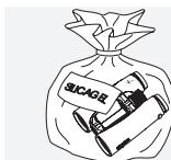
Ist das Fernglas nass, muss es vorher getrocknet werden. In Tropengebieten oder in Gegenden mit hoher Umgebungsfuchtigkeit ist der beste Lagerort ein luftdichter Behälter mit einem Feuchtigkeits-Absorptionsmittel (z.B. Silikagel).
